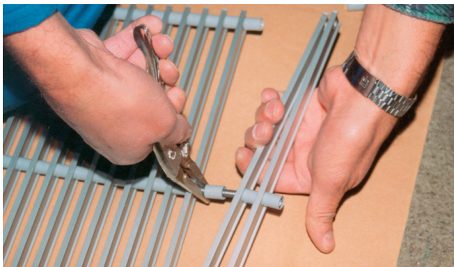
Schritt 6: Kürzen an den übrigen Federn des Rostes
